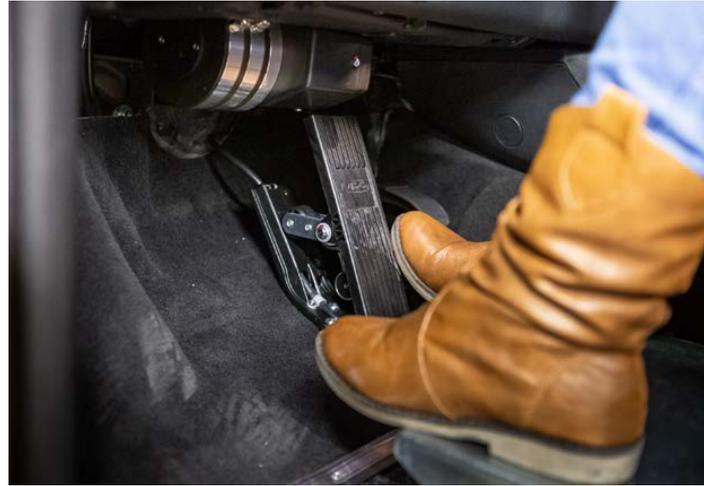
Bremse, gesteuert über das Drive-by-wire-System „Space Drive“, machen die Bedienung möglich. „Die Bremse hat keinen Widerstand, geht gleichmäßig nach unten und kann ganz individuell eingestellt werden“, erklärt Norbert Peschke, bei Paravan zuständig für die technische Beratung.
